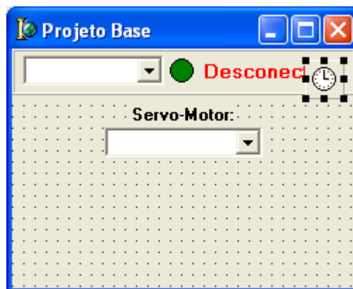
Figura 6: Form após adição dos componentes para seleção do servo-motor que será controlado.
