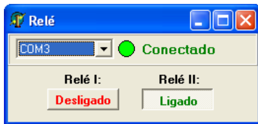
Figura 2: Interface do programa de controle dos relés que será criado nesse tutorial.
