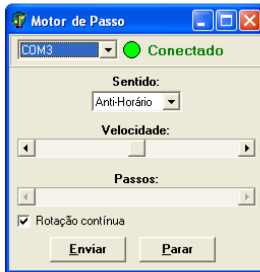
Figura 14: Quando o CheckBox de rotação contínua for selecionado o ScrollBar de número de passos é desabilitado.
