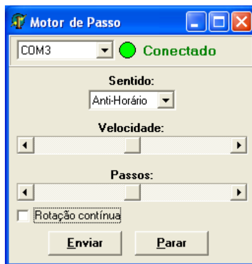
Figura 15: Quando o CheckBox de rotação contínua não estiver selecionado o ScrollBar de número de passos fica habilitado.
