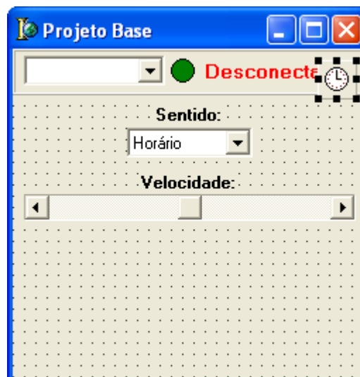
Figura 8: Form com controles para ajuste de sentido e velocidade da rotação.
