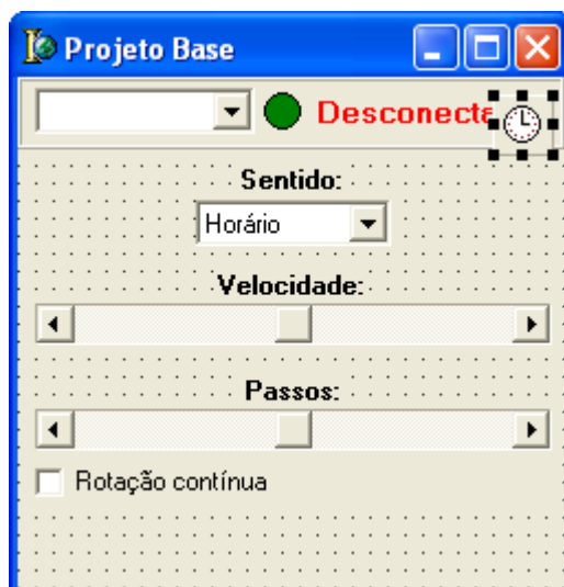
Figura 10: Interface com todos os controles para ajuste do sentido, velocidade e número de passos da rotação.
