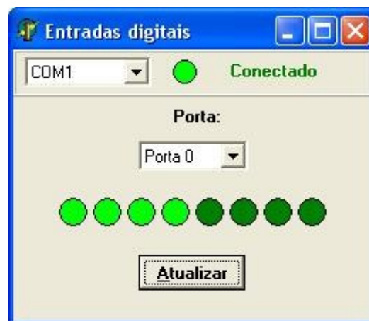
Figura 14: Leitura da porta com o estado setado para 11110000b.
