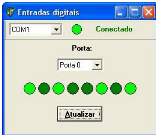
Figura 13: Leitura da porta com o estado setado para 10100101b.
