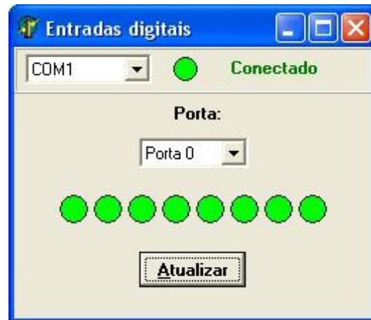
Figura 12: Leitura da porta com todos os bits setados para "1", ou seja, 11111111b.
