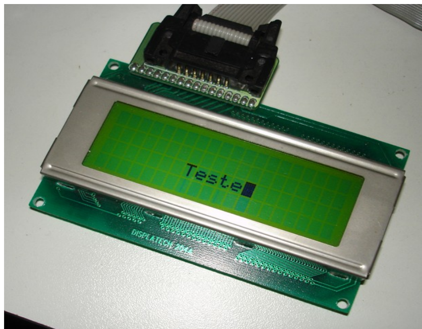
Figura 15: LCD com visualização do cursor acionada, luz de fundo ligada e uma mensagem de texto “Teste” na linha 2 e coluna 7.
