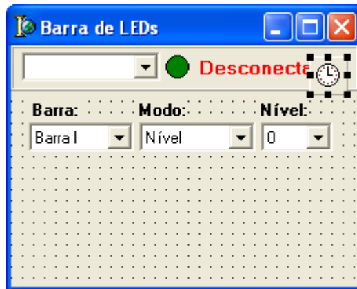
Figura 8: Aparência do Form após a adição dos componentes para seleção de nível.
