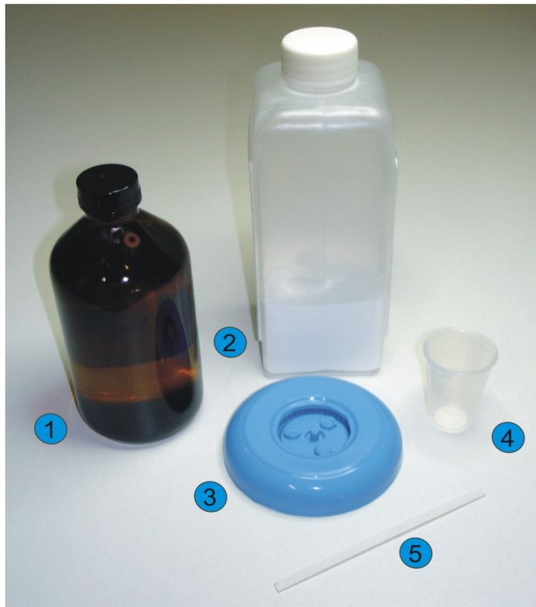
**Figura 6:** Material utilizado na produção da peça. 1-Catalisador. 2-Acrílico em pó. 3-Molde. 4-Copo graduado. 5-Palito fino.
