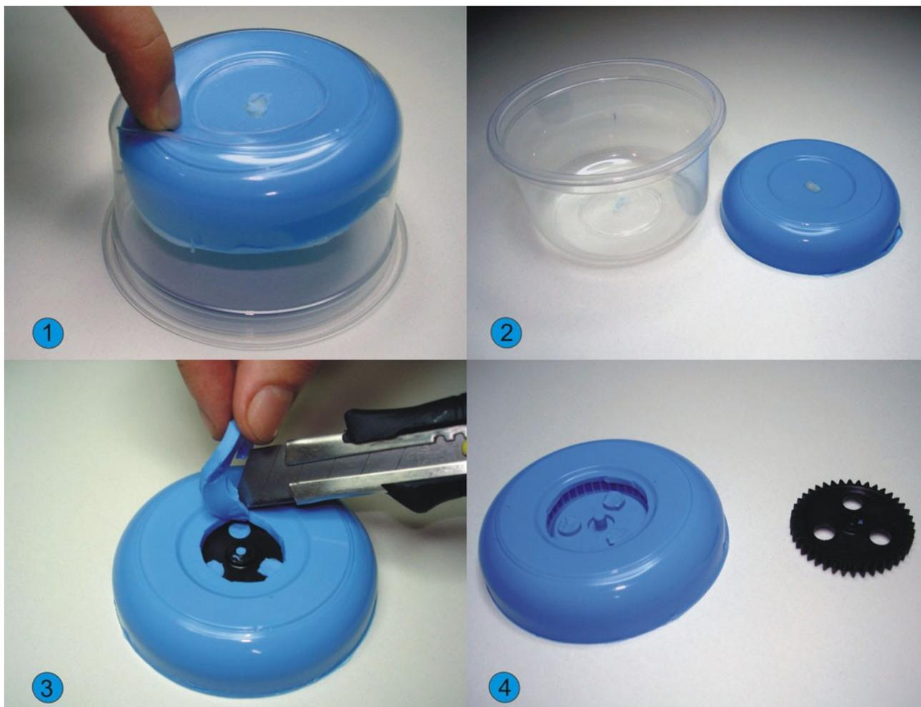
**Figura 4:** Preparação do molde de silicone. 1-Molde sendo retirado do pote. 2-Molde já retirado. 3-Para retirar a engrenagem, corte o molde com cuidado. 4-Engrenagem retirada do molde.
