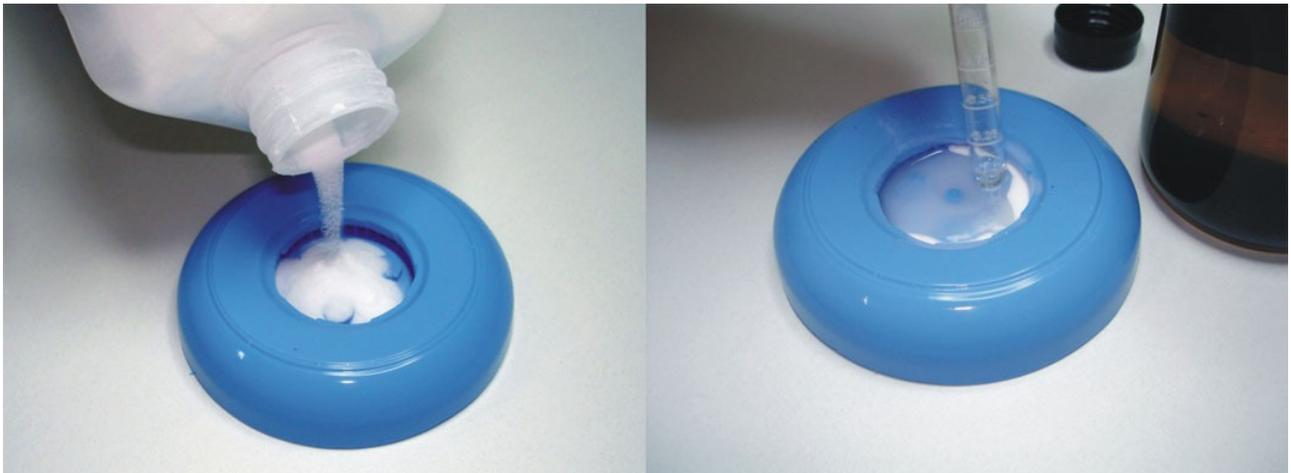
*Figura 7: Acrílico em pó e catalisador sendo colocados no molde.*
