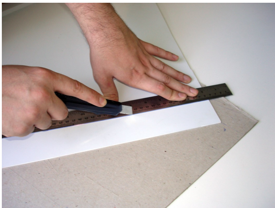
Figura 7: Cortando a peça de PVC. É recomendado cortá-la sobre um pedaço de papelão, para evitar danos à mesa ou bancada onde o procedimento será feito.
