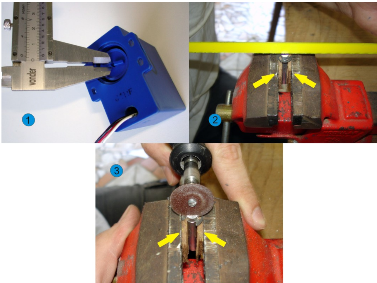
Figura 4: Fazendo o corte para encaixar o pino-eixo ao motor. 1-Verificando a largura da saliência do eixo do servo-motor. 2-Fazendo o corte com a serra. É necessário muito cuidado ao fazer o corte. As duas flechas amarelas indicam os blocos de madeirite, colocados para absorver parte da força que a morsa exerce sobre a barra de alumínio. 3-Caso o corte feito com a serra não for suficiente, utilize a microrretífica com o disco de corte para aumentá-lo levemente.
