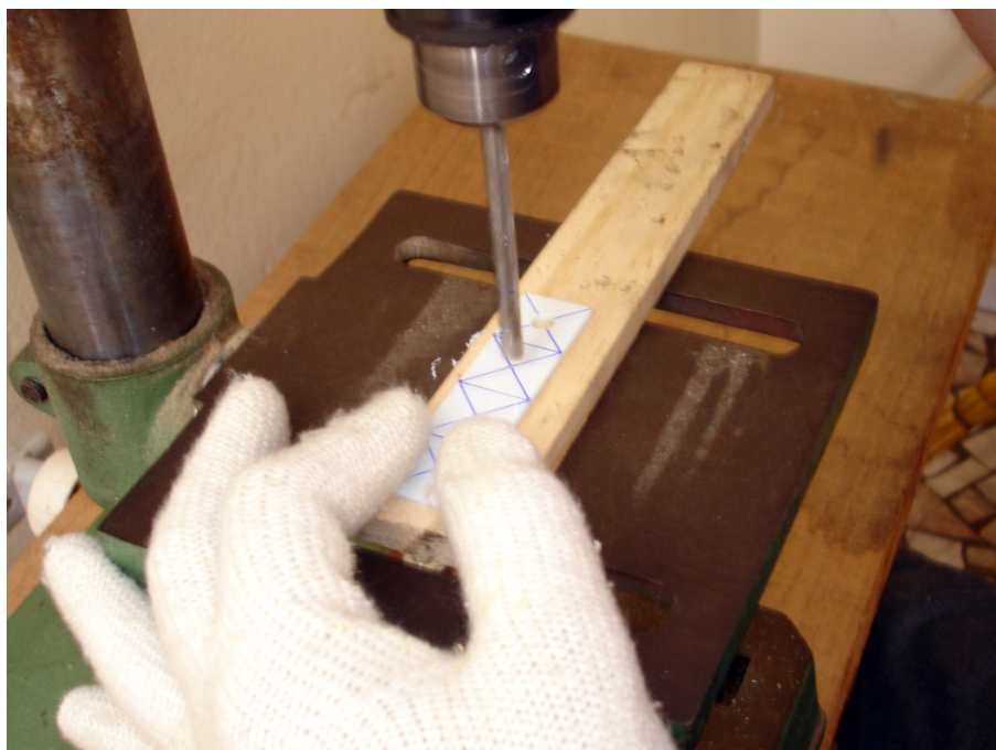
Figura 16: Exemplo de procedimento realizado para facilitar a montagem. Durante a criação de arruelas de plástico, é recomendado fazer as marcações, furar as peças só depois cortá-las no tamanho ideal.
