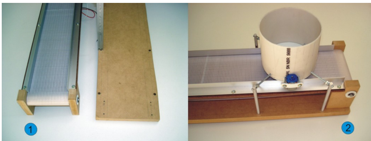
Figura 25: Alimentador sendo colocado na esteira principal. 1-Furos feitos na base de sustentação. 2-Alimentador pronto.
