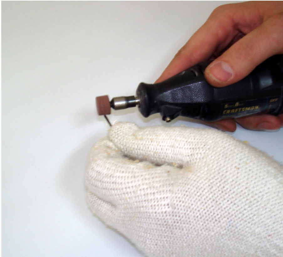
Figura 36: Adequando os pregos com a microrretífica, com o acessório de lixa, para que não danifiquem as engrenagens.
