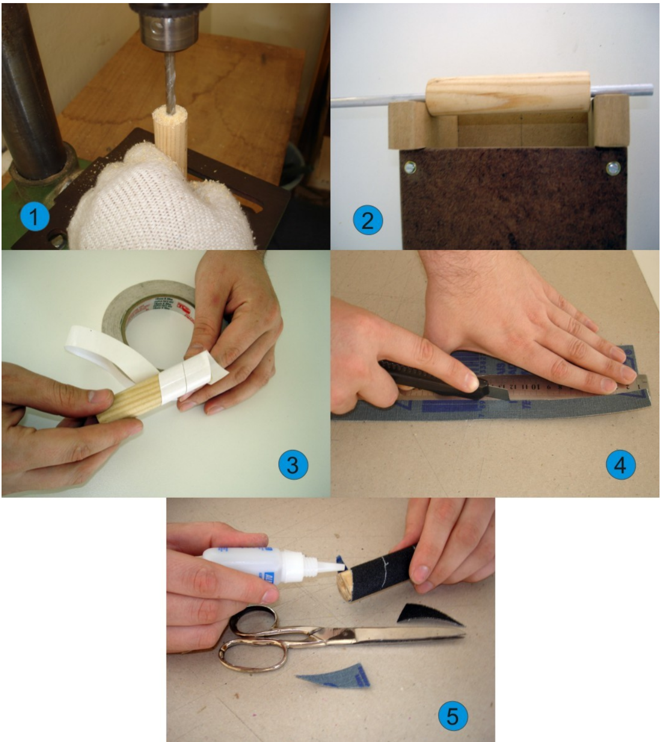
Figura 8: Procedimentos para a criação do rolo. 1-Utilizando um cabo de vassoura, fazemos um furo central para o eixo. 2-Verificando o tamanho do rolo. 3-A fita dupla face é utilizada para colar a lixa. 4-Lixa sendo cortada com o estilete. Sempre ao utilizar o estilete, lembre-se de proteger a superfície sobre a qual será feito o corte com um pedaço de papelão, por exemplo. 5-As extremidades da lixa deverão ser coladas com cola de secagem instantânea, evitando que ela se solte. Os dois últimos procedimentos não precisam ser feitos no eixo que não traciona.
