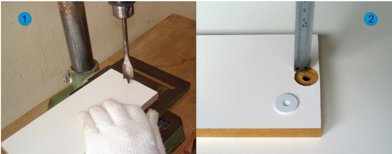
Figura 34: Perfurando a parte inferior da base da balança para a colocação do pino do prato giratório. 1-Primeiramente, o furo na base da balança deverá ser feito com a broca de 1/8". Então, deverá ser feita uma reentrância com a broca para madeira, com aproximadamente 3 mm de profundidade. 2-Conferindo a profundidade da reentrância, antes de colar a arruela de plástico. Observe que o furo central já foi alargado, com a broca de 8 mm.
