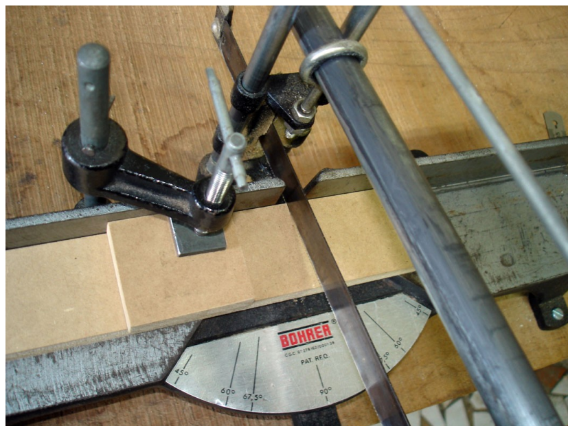
Figura 2: Cortando o MDF na serra de meia-esquadria para a criação das peças de sustentação.
