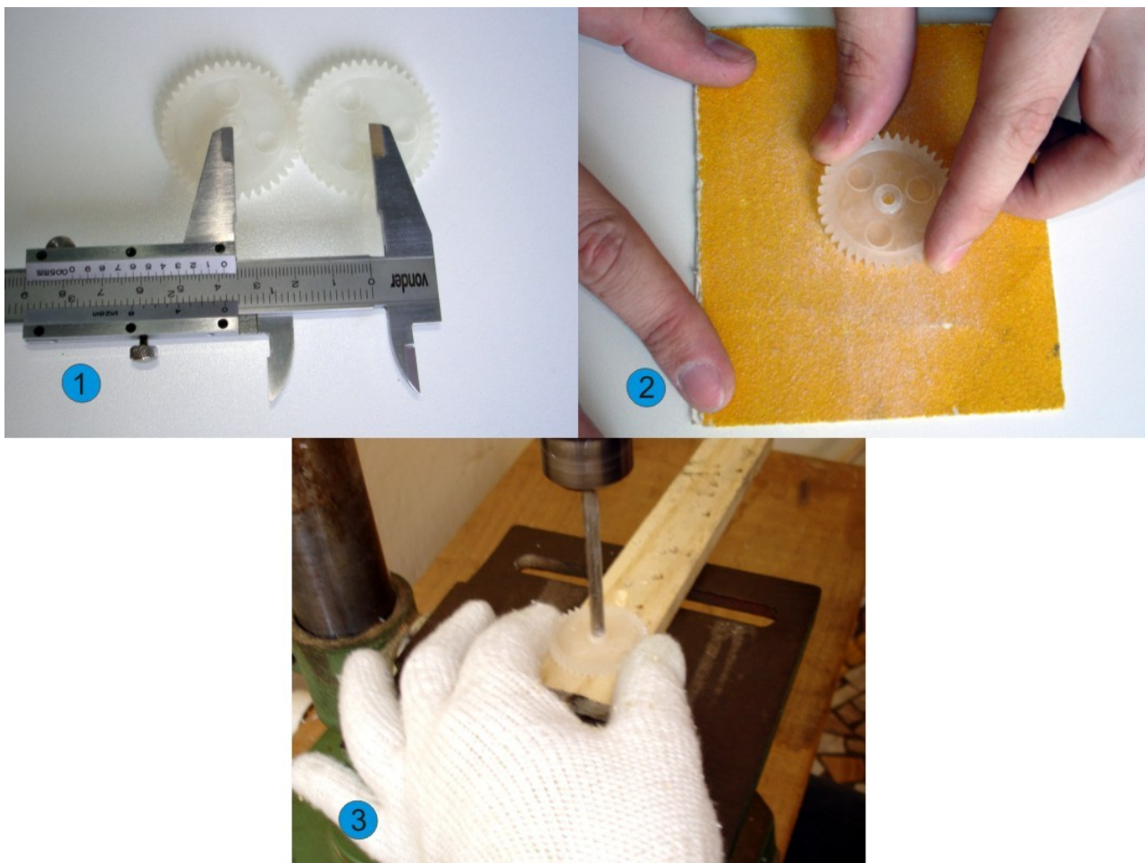
Figura 10: 1-Medindo a distância entre os centros das engrenagens, para definir a posição do servo-motor na peça de sustentação. 2-Lixando as engrenagens, de modo a torná-las planas. 3-Perfurando as engrenagens.
