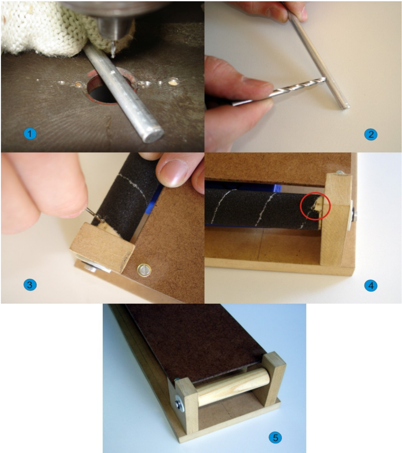
Figura 17: Fixação do rolo ao eixo da esteira. 1-Eixo sendo furado com broca de 1,5 mm. 2-Rebarbas sendo retiradas com uma broca pouco maior que o furo. 3-Rolo furado com a broca de 1,5mm. 4-Rolo preso ao eixo através de um arame (observe o detalhe). 5-O eixo traseiro não necessita desse procedimento, apenas da colocação de arruelas e travas.
