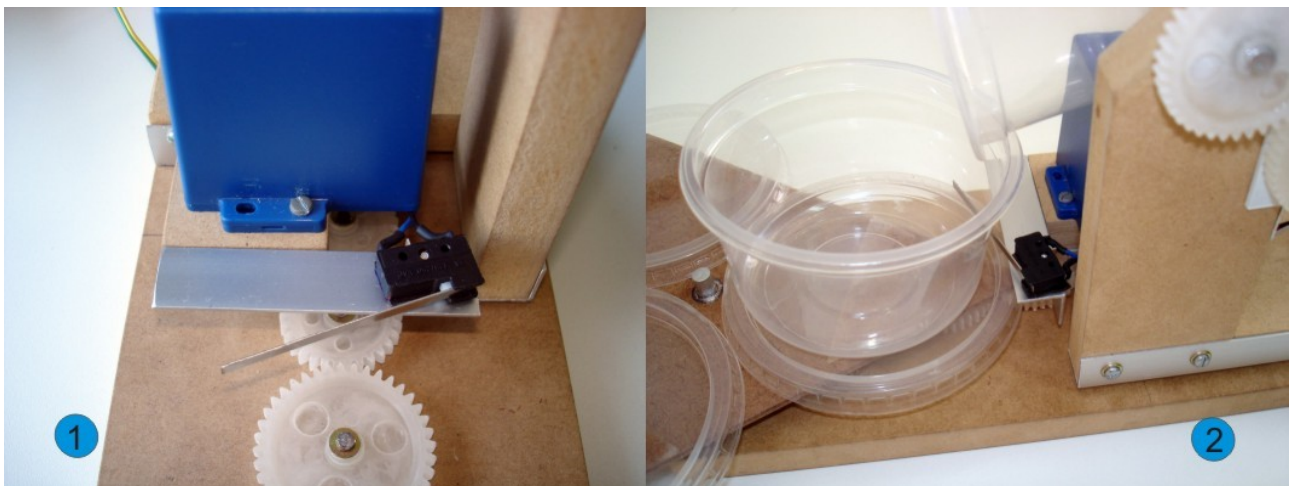
Figura 49: Chave de fim-de-curso. 1-Visão da posição a qual a chave foi colocada. 2-Verificando o seu funcionamento. O pote coletor de grãos deverá acioná-la quando o prato giratório se movimentar.
