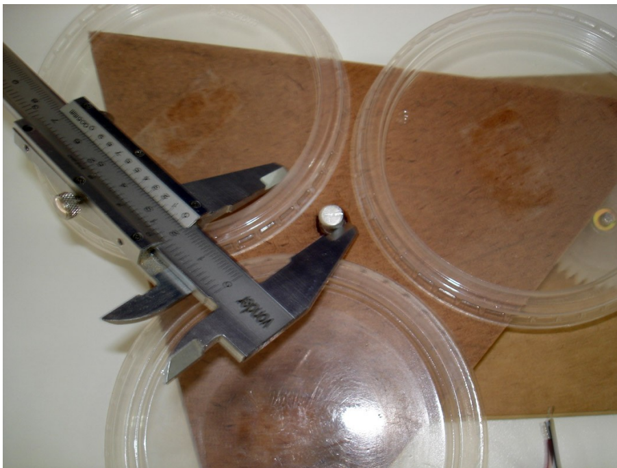
Figura 43: Verificando o posicionamento dos suportes do prato giratório.
