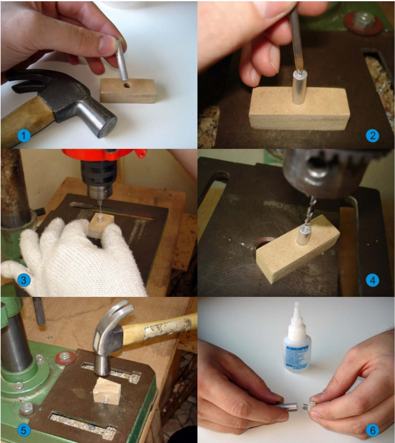
Figura 39: Criação do pino-eixo do servo-motor do prato giratório. 1-Pequeno bloco de madeira para o encaixe do pino-eixo. Ele deve se manter firmemente preso à esse bloco. 2-Marcação no pino-eixo do furo para o encaixe do parafuso. 3-Pino-eixo sendo perfurado com a broca de 1/8". É importante que o furo não seja torto nem muito profundo. 4-Pino-eixo já perfurado. 5-Para retirar o pino-eixo do bloco de madeira, deve-se martelar esse bloco até que ele se abra. 6-O parafuso com a engrenagem pode então ser colado ao furo do pino-eixo com a cola de secagem instantânea.
