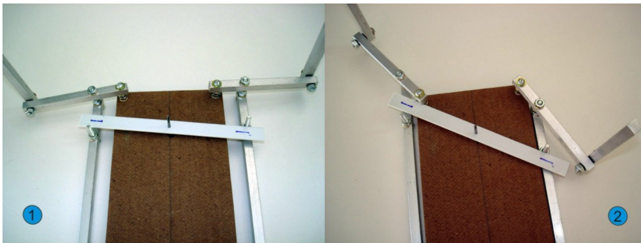
Figura 10: Verificando as dimensões do furo para a haste, de acordo com a angulação das pernas.
