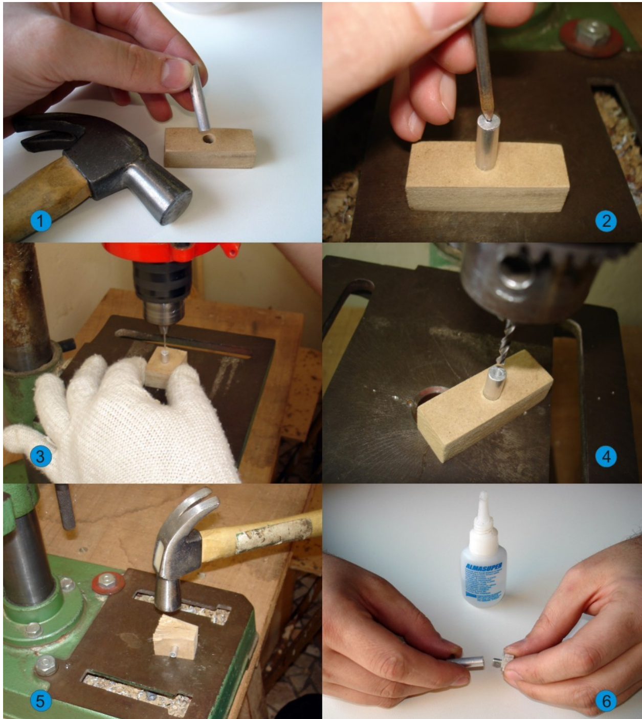
Figura 20: Criação do pino-eixo 1-Pequeno bloco de madeira para o encaixe do pino-eixo. Ele deve se manter firmemente preso à esse bloco. 2-Marcação no pino-eixo do furo para o encaixe do parafuso. 3-Pino-eixo sendo perfurado com a broca de 1/8". É importante que o furo não seja torto nem muito profundo. 4-Pino-eixo já perfurado. 5-Para retirar o pino-eixo do bloco de madeira, deve-se martelar esse bloco até que ele se abra. 6-O parafuso com a engrenagem pode então ser colado ao furo do pino-eixo com a cola de secagem instantânea.
