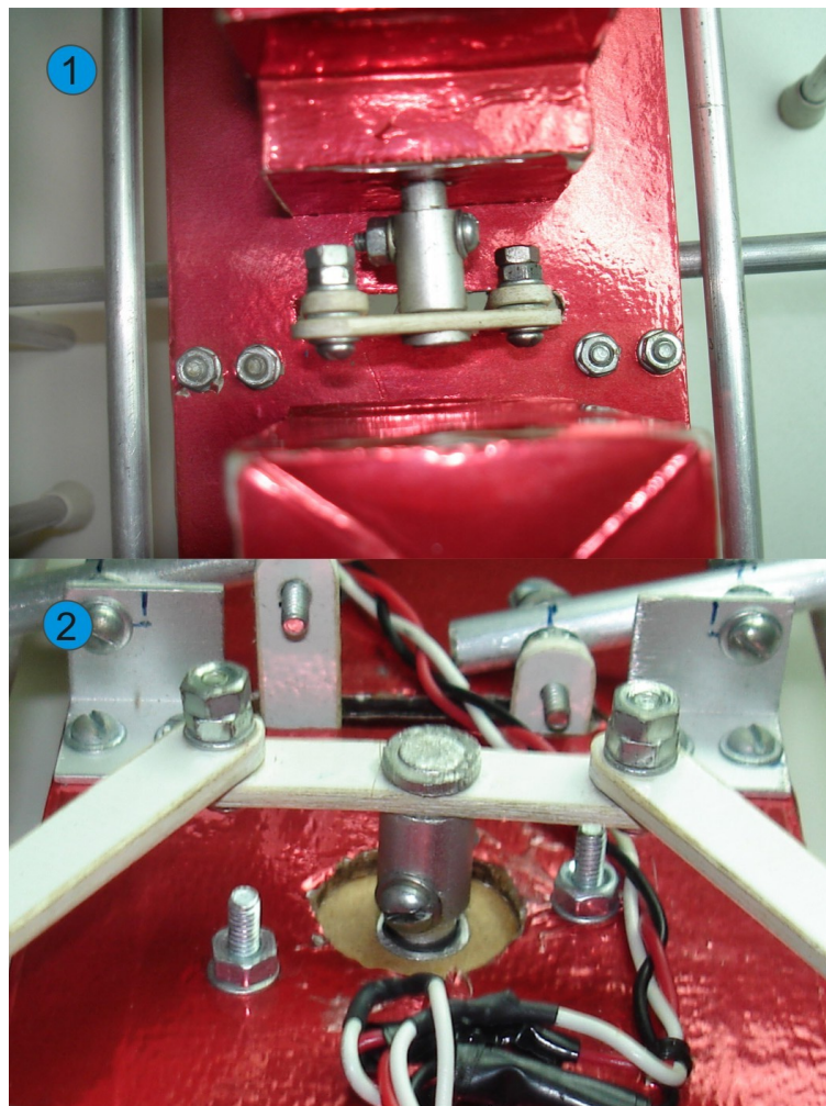
Figura 40: Visões da haste colocada no eixo do servo-motor, onde são fixadas as hastes de transferência de movimento. 1-Visão do bloco de movimentação vertical. 2-Visão do bloco de movimentação horizontal.
