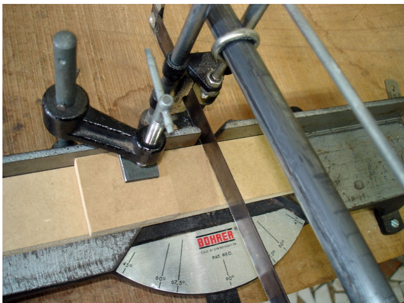
Figura 16: Cortando o MDF na serra de meia-esquadria para a criação dos blocos de servo-motor.
