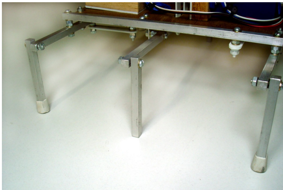
Figura 37: “Sapatos” de borracha colocados nas pernas das extremidades, proporcionando maior aderência. As pernas centrais não necessitam deles, pois devem deslizar.
