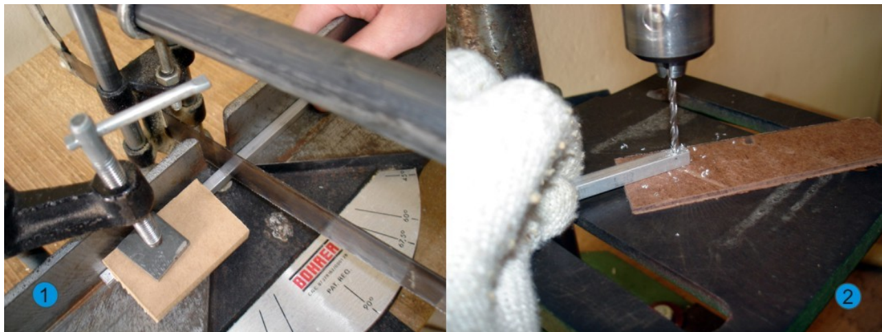
Figura 4: Preparando as antepernas do inseto. 1-Cortando a barra de alumínio na serra de meia-esquadria. 2-As barras deverão ser furadas, de preferência com a furadeira de bancada.
