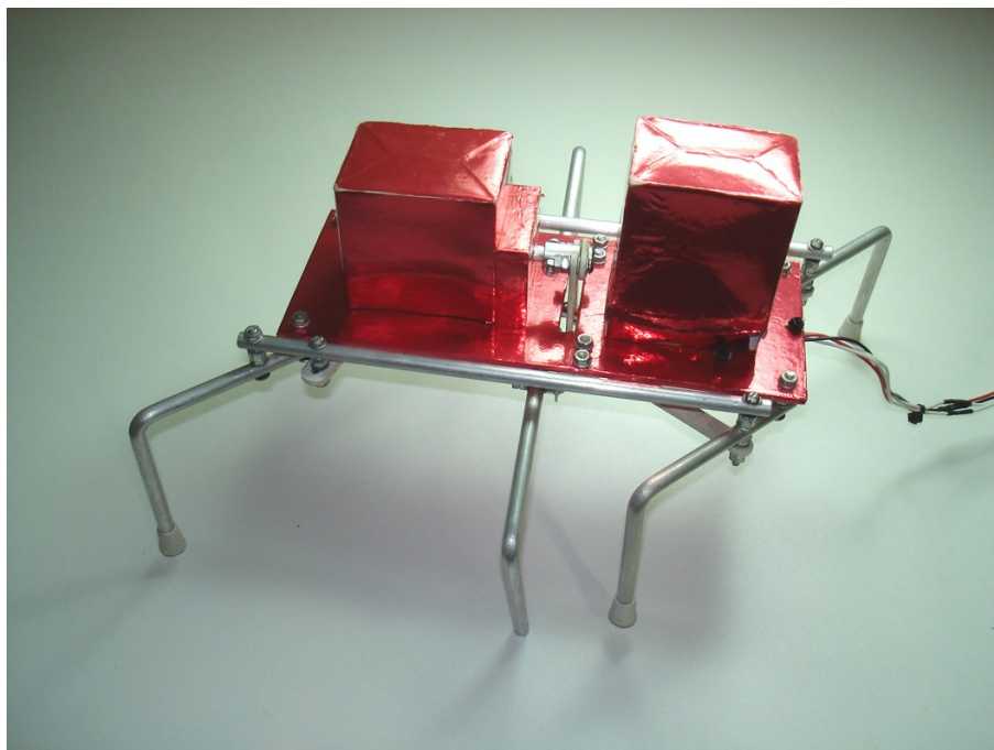
Figura 39: Versão do robô inseto sem engrenagens de redução. Observe que este modelo conta com um acabamento, feito com papel laminado vermelho.
