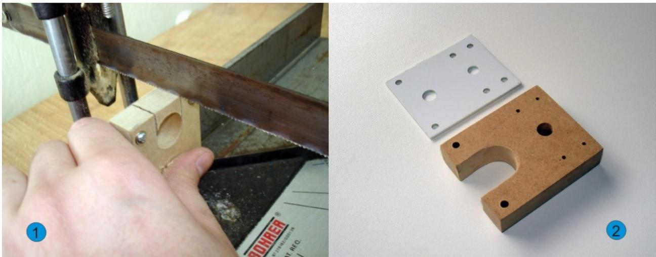
**Figura 6:** Finalizando as peças do bloco do servo-motor. 1-Corte do bloco de madeira para o encaixe do potenciômetro. 2-Bloco de madeira e de plástico prontos.
