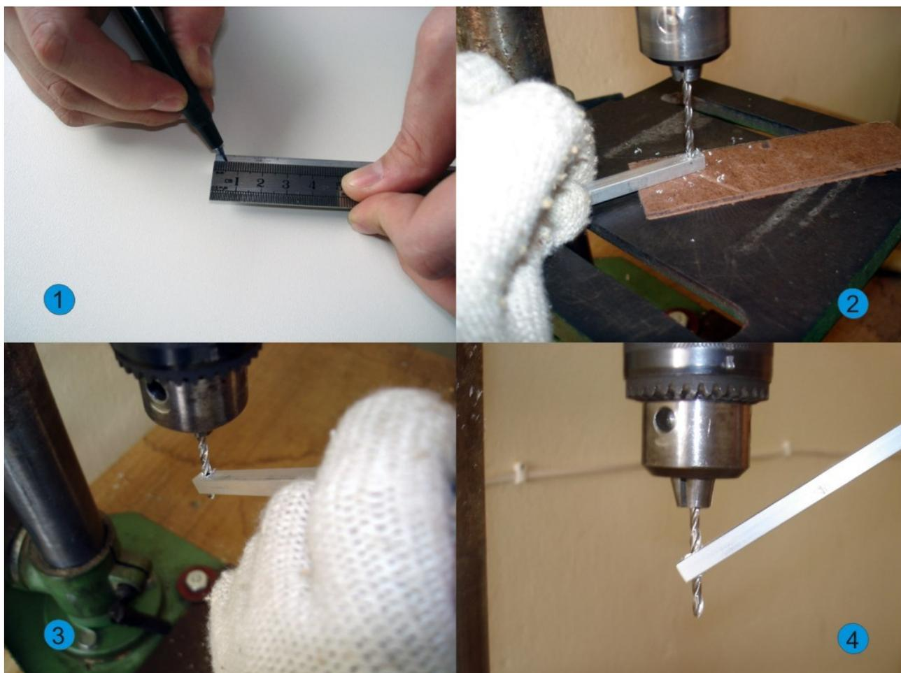
**Figura 16:** Procedimentos para a criação das pernas do bípede. 1-Deve ser feito um furo a 5 mm da extremidade. 2-Furo sendo feito. 3 e 4-Para espaçar a abertura do furo, a barra de alumínio deverá ser movida para cima e para baixo.
