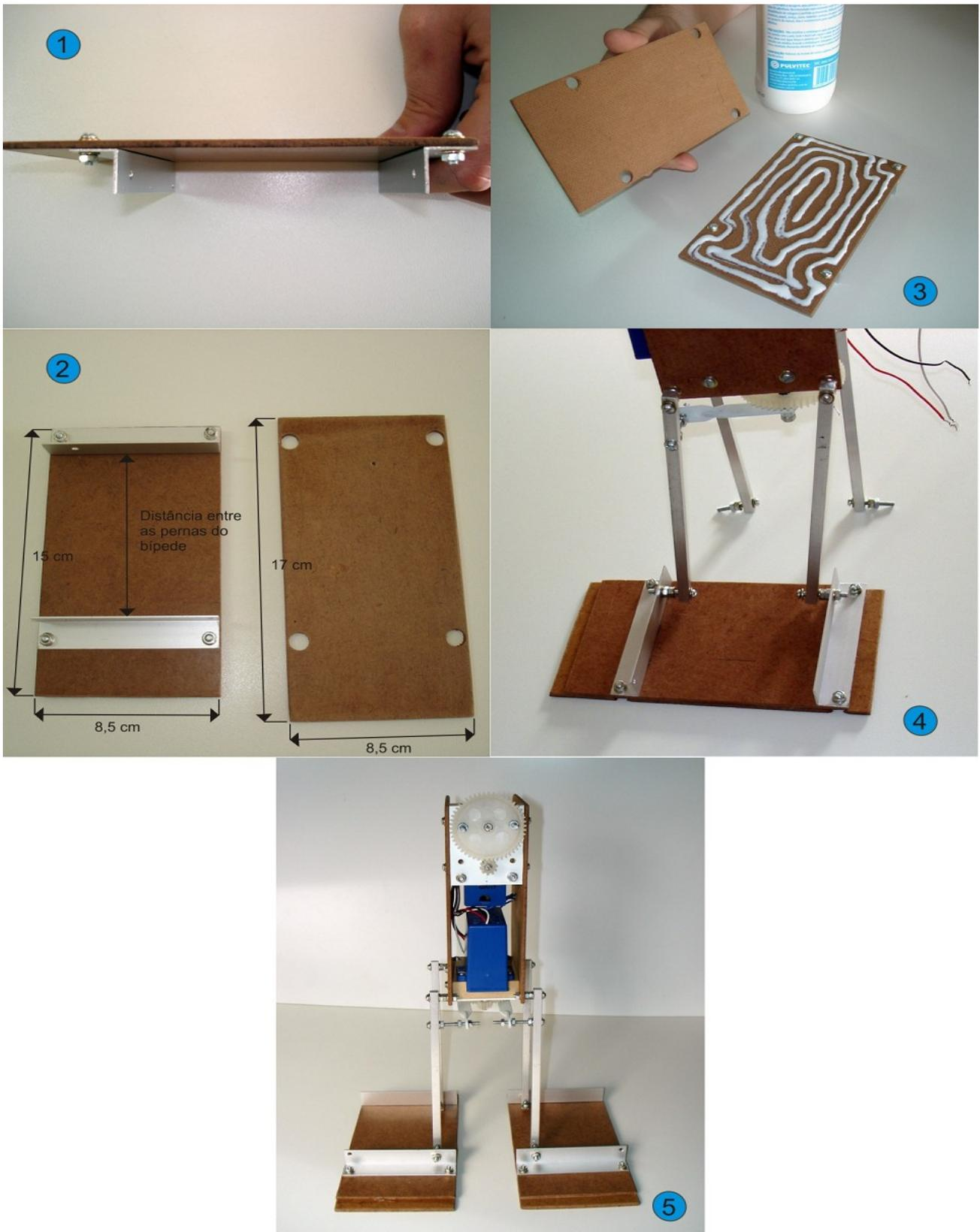
**Figura 23:** Finalizando a construção dos pés do bípede. 1-Cantoneiras presas aos pés através de parafusos. 2-Dimensões dos pés e dos sapatos do bípede. 3-Os sapatos podem ser colados aos pés com cola branca. 4-Fixando os pés às pernas do bípede. 5-Bípede com os pés completos.
