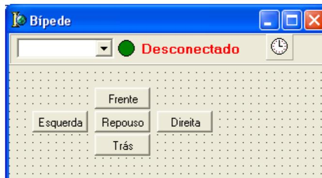
*Figura 30: Form após a adição dos SpeedButton para controle do bípede.*
