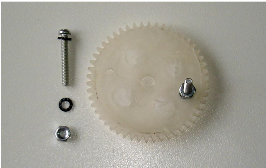
*Figura 10: Engrenagem responsável pela redução e transferência do movimento para as pernas.*
