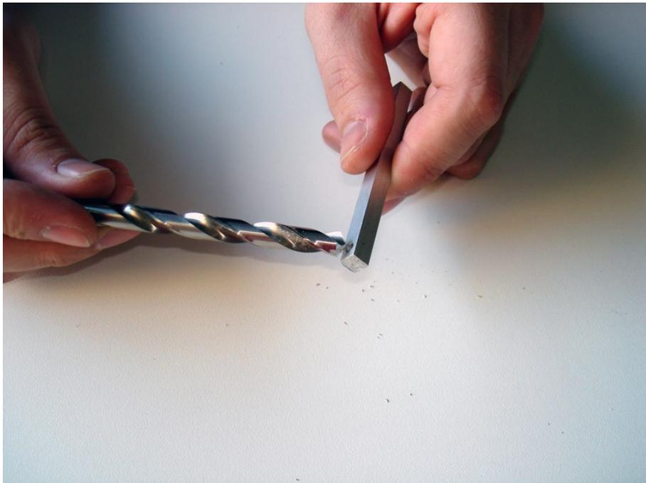
**Figura 17:** Para retirar as rebarbas, basta utilizar uma broca maior que o furo feito e girá-la levemente.
