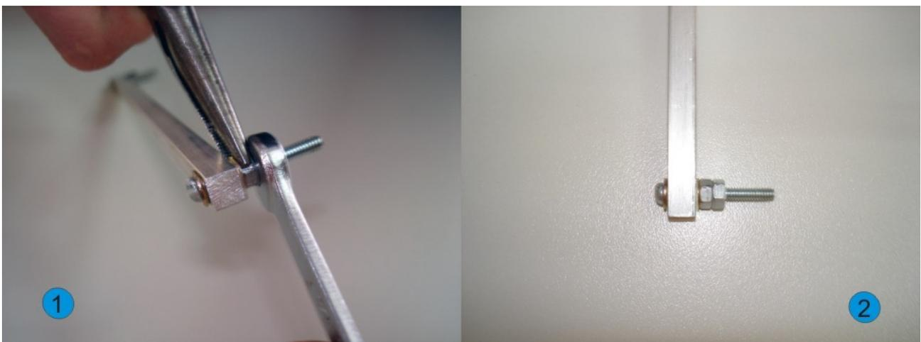
**Figura 18:** Colocando parafusos e porcas na perna do bípode. 1-Enquanto uma das porcas é presa com uma chave de boca, outra é regulada através de um alicate de bico. 2-Porcas e arruelas colocadas.
