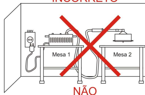
Figura 6.3 – Método Incorreto de Instalação da Máquina de Flocagem
