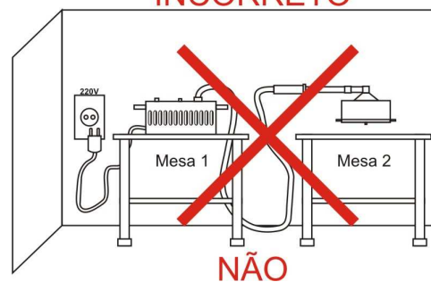
Figura 6.3 – Método Incorreto de Instalação da Máquina de Flocagem
