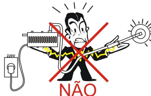
Figura 3.1 – Método Incorreto de manusear a Máquina de Flocagem
